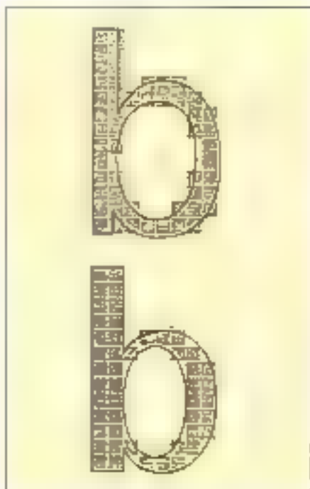
Fig. 4. - Affinement de la représentation Bitmap en utilisant les commandes du langage TrueType.
